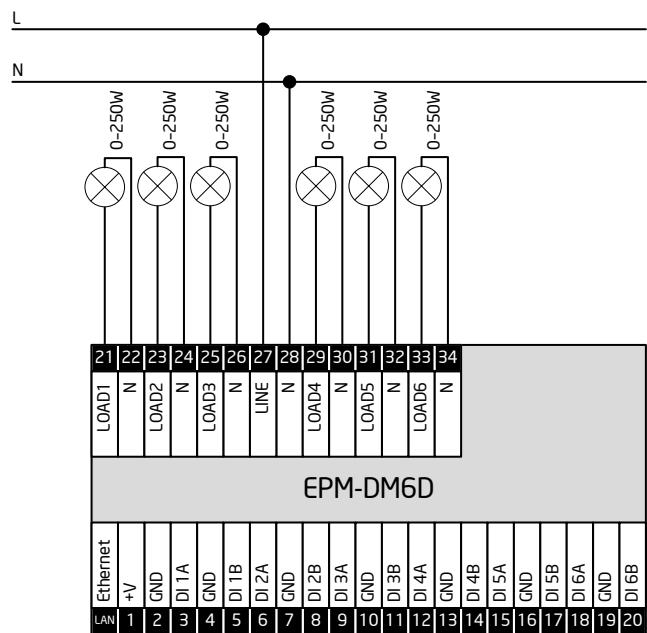
Схема 2. Шесть независимых каналов.
