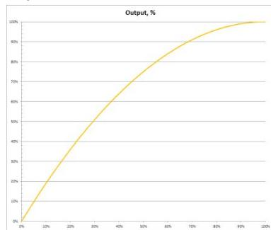
На представленных графиках значения по горизонтали - значения уровня интерфейса управления (HTTP-страница, протоколы NetString, ModBus, ICSP), по вертикали - реальная выходная мощность канала. В случае данного устройства - длительность открытия выходного канала (в процентах) в течение каждого полупериода сети питания переменного тока.
