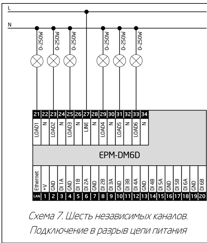
Схема 7. Шесть независимых каналов.
