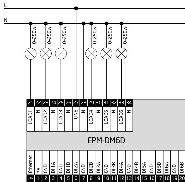
Схема 1. Шесть независимых каналов.
