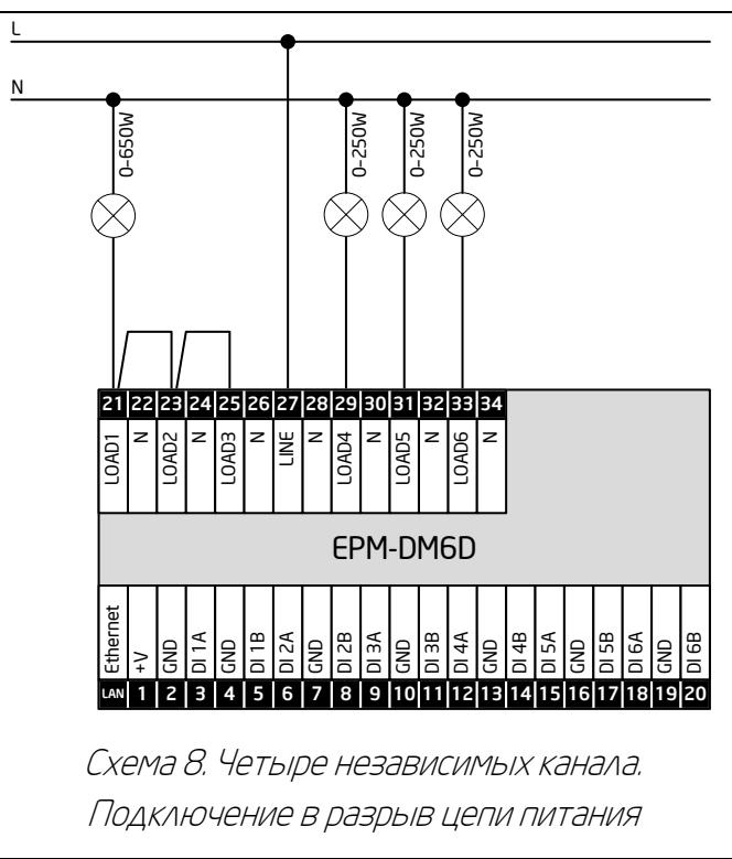
Схема 8. Четыре независимых канала.
