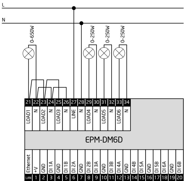
*Схема б. Объединение каналов 1+2+3.
